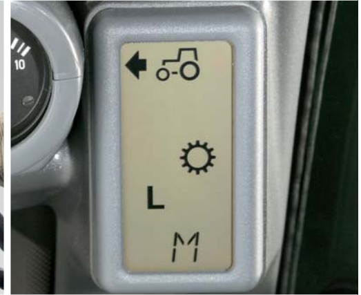
L'affichage central des passages de rapports sous charge se trouve dans le champ visuel, sur le montant latéral.
