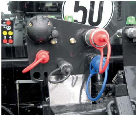
L'Agrotron M est doté sur demande de prises Power-Beyond pour le raccordement direct d'outils.
