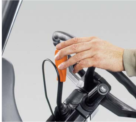
Changement de sens de marche sans débrayer avec le Powershuttle en série.
