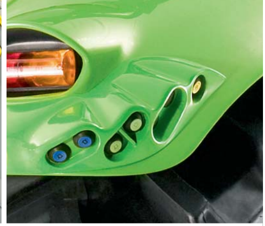
Dans l'actionnement à l'arrière des versions ProfilLine, la commande d'un distributeur auxiliaire peut être intégrée sur demande.
