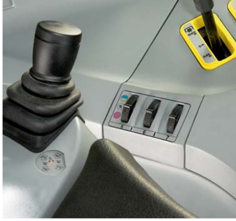
Jusqu'à six distributeurs auxiliaires peuvent être commandés.
